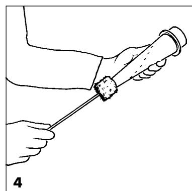
**Bild 4** Reinigen Sie den Kreisel mit der mitgelieferten Bürste.
