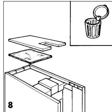
**Bild 8** Ersetzen Sie ihn, wenn er stark verschmutzt ist.
