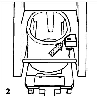
**Figure 3** La barre transversale doit être introduite exactement dans l'évidement.
