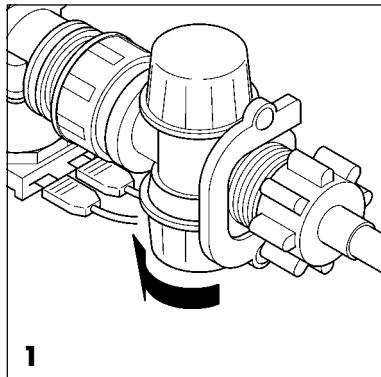
**Bild 2** Achten Sie beim Montieren des Gehäuses darauf, dass die Niveauschalterabdeckung am Quattrofilter vorbeigleitet.
