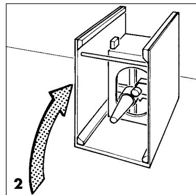
**Bild 3** Ziehen Sie den Kreisel gerade aus der Kupplung heraus.
