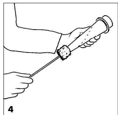
**Figura 5** PH14: Pulire l'evaporatore, il separatore di gocce, il doppio fondo e il telaio mobile.
