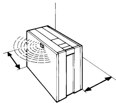
**Attenzione!** La parte più grande dei cluster di polvere formatisi grazie all'ionizzazione inserita viene trattenuta nel filtro d'aria. Però è possibile, specialmente quando l'aria del locale è particolarmente sporca, che una piccola parte dei cluster di polvere si posi sulle pareti o su altre superfici del locale. Non collocare il PH14 plus nelle immediate vicinanze di una parete o di una tenda. Decliniamo ogni responsabilità per l'eventuale deposito di polvere sulle superfici.
