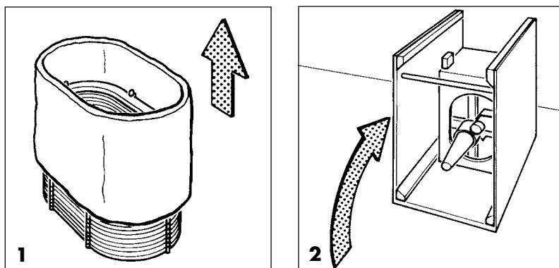
**Figure 3** Retirer en ligne droite la pompe centrifuge hors de l'accouplement. Nettoyer l'interrupteur à flotteur (PH14A: interrupteur de sécurité supplémentaire).
