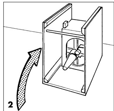
**Figura 3** Estrarre la centrifuga perpendicolarmente all'innesto.
