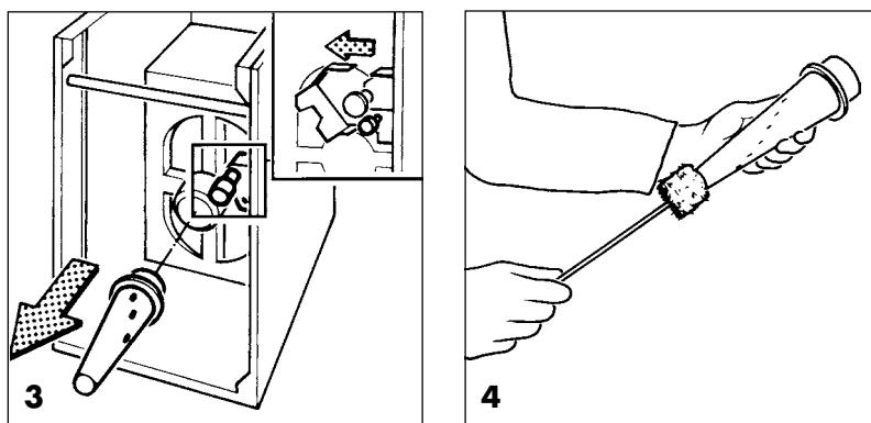
**Figure 5** PH14: Nettoyer la natte d'évaporation, l'élément séparateur, le fond intermédiaire et le châssis roulant.
