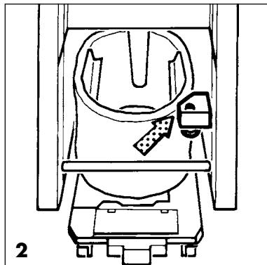
**Bild 3** Die Querstange muss genau in die Aussparung gesetzt werden.
