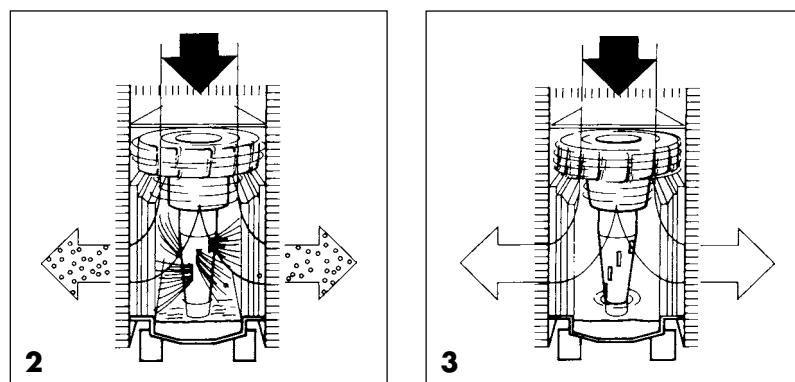
Wenn der Istwert (z.B. 40) kleiner ist als der Sollwert (z.B. 45), befeuchtet das Gerät die Raumluft und reinigt sie gleichzeitig.
