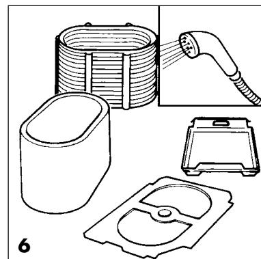
**Bild 6** PH14A: zusätzlich Wasserwanne reinigen.
