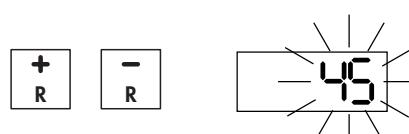
Nach längerem Stillstand des Gerätes kann die genaue Raumluftheuchtigkeit erst nach ca. 30 Min. abgelesen werden. Beim Wegfahren des Wasserwagens schaltet die Anzeige aus. Nach dem Wiedereinschalten kann die genaue Raumluftheuchtigkeit erst nach ca. 1 Min. abgelesen werden.
