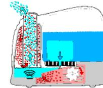
SANVIA Ultraschallvernebler wandeln Wasser mittels Hochfrequenzschwingungen in mikrofeinen Nebel um, der an den Raum abgegeben wird und dort sofort verdunstet. Für hygienisch reinen Wassernebel ohne Kalk- und Mineralienrückstände sorgt eine leistungsstarke, austauschbare Entkalkungspatrone.
