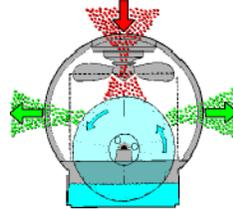
Der Luftwäscher saugt Luft an, befeuchtet sie über langsam drehende Kunststoffscheiben und gibt sie wieder an den Raum ab. Weil die Luft je nach Temperatur mehr oder weniger Feuchtigkeit aufnimmt, sorgt der Luftwäscher automatisch für die richtige Luftfeuchtigkeit – zusätzliche Steuergeräte werden nicht benötigt.
