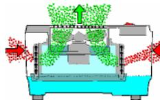
SANVIA Verdunster saugen Luft an, befeuchten sie via Verdunsterkassetten und geben sie wieder an den Raum ab. Weil die Luft je nach Temperatur mehr oder weniger Feuchtigkeit aufnimmt, sorgen Verdunster automatisch für die richtige Luftfeuchtigkeit – zusätzliche Steuergeräte werden nicht benötigt.
