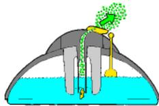
SANVIA Verdampfer erhitzen Wasser mittels Strom und geben es in Form von Dampf an den Raum ab. Verdampfer sind extrem leistungsstark. Deshalb ist die Befeuchtung bevorzugt mit einem Steuergerät zu kontrollieren. Dank integrierter Duftstoffrinne können Verdampfer zudem bei Erkältungen als wirkungsvolle Heiss-Inhalatoren verwendet werden.
